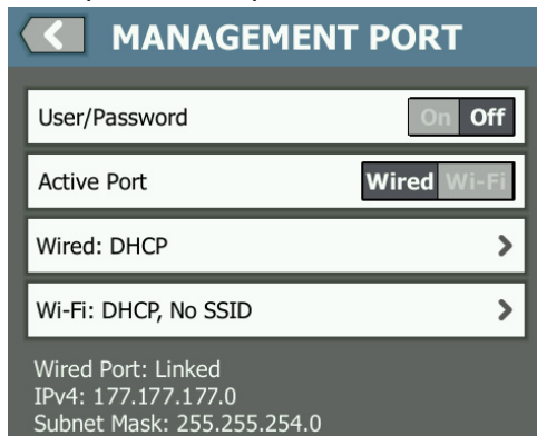
Abbildung 18. IP-Adresse des Management-Ports
