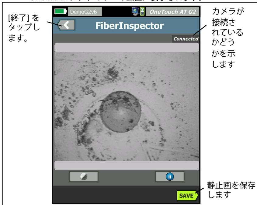
図 124. 端面の FiberInspector 画像
