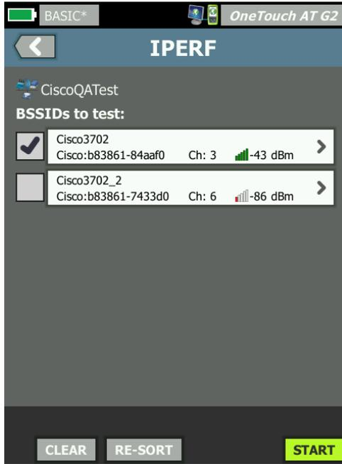
그림 120. iPerf 검사를 위한 BSSID 선택
