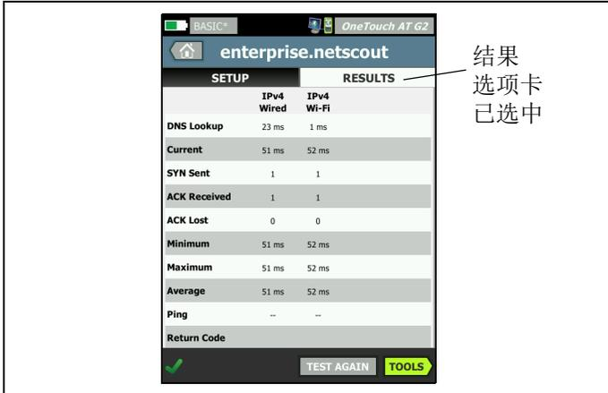
图 27. “连接”(TCP)测试结果选项卡
