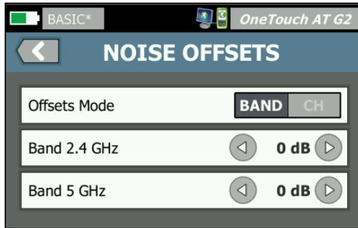
图 25. 已选定频段的噪声偏差屏幕
