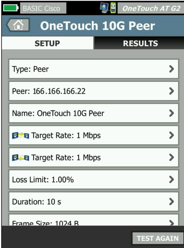
图 71. 有线性能测试设置选项卡
