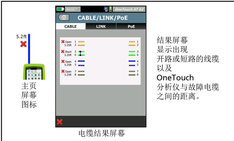
图 34. 末端接电缆存在短路和开路
