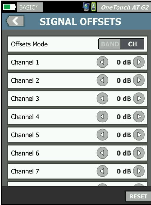
图 24. 已选定信道的信号偏差屏幕
