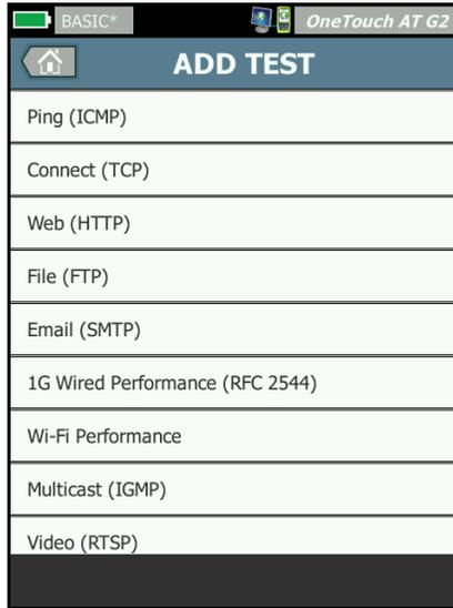
图 52. “添加测试” (ADD TEST) 屏幕
