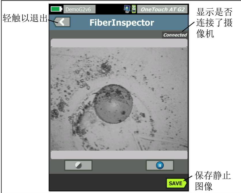
图 134. 端面的 FiberInspector 图像
