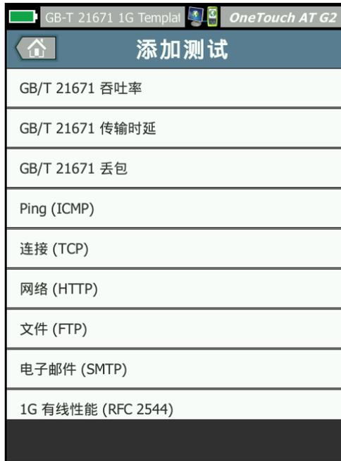
图 53. 包含 GB/T 21671 测试的 ADD TEST（添加测试）屏幕
