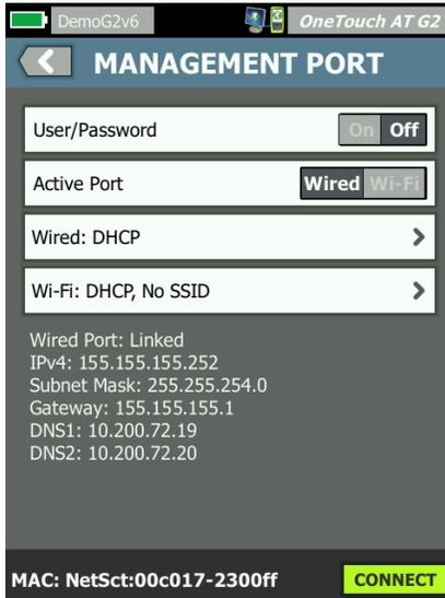
图 142. 管理端口屏幕（已连接有线）
