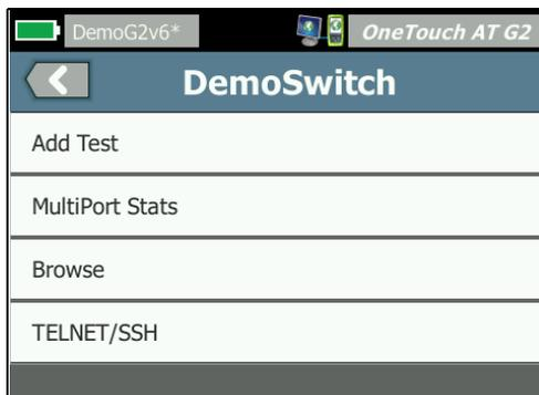
图 88. 路径分析工具菜单上的多端口统计信息按钮
