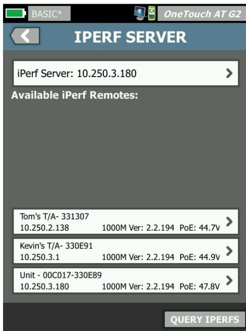
Imagen 120. Pantalla del servidor de iPerf
