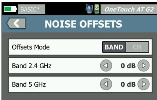
Figura 25. Pantalla Desplazamientos de ruidos con bandas seleccionadas
