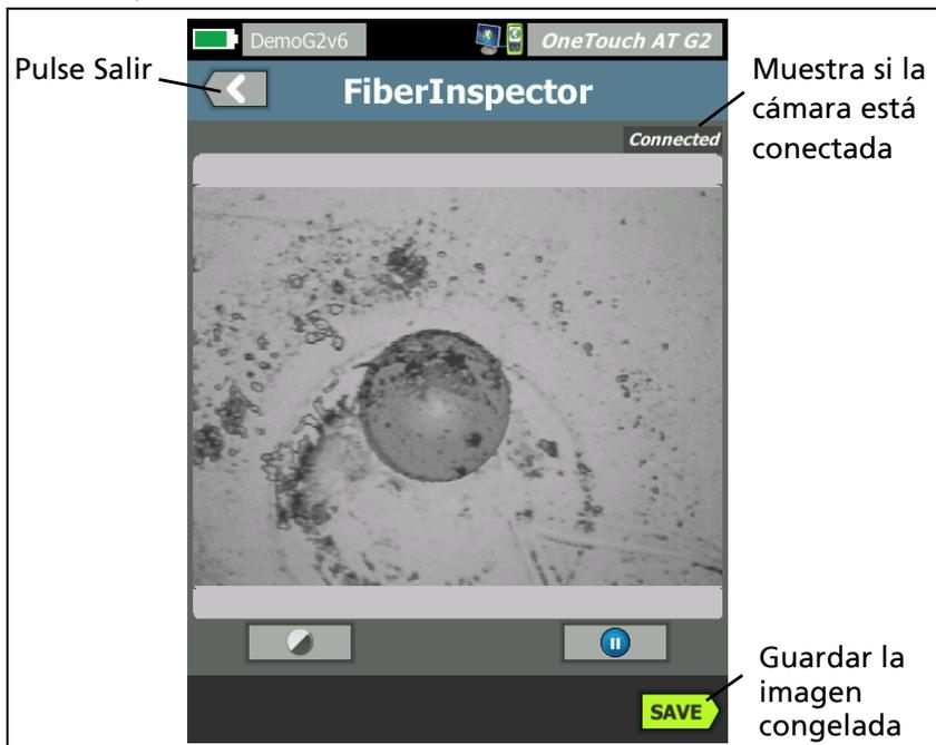
Figura 126. Imagen de un extremo de FiberInspector
