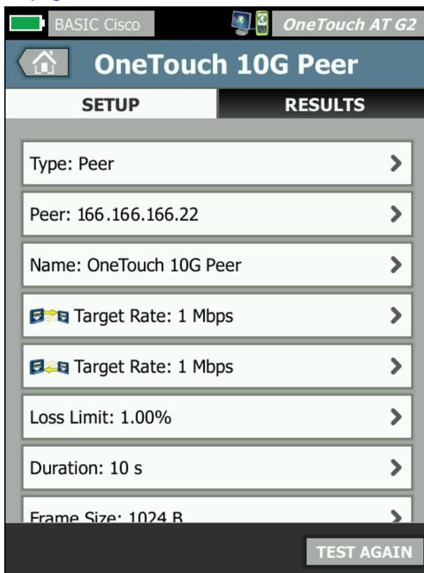
Figura 61. Pestaña de ajustes de la prueba de rendimiento de red alámbrica
