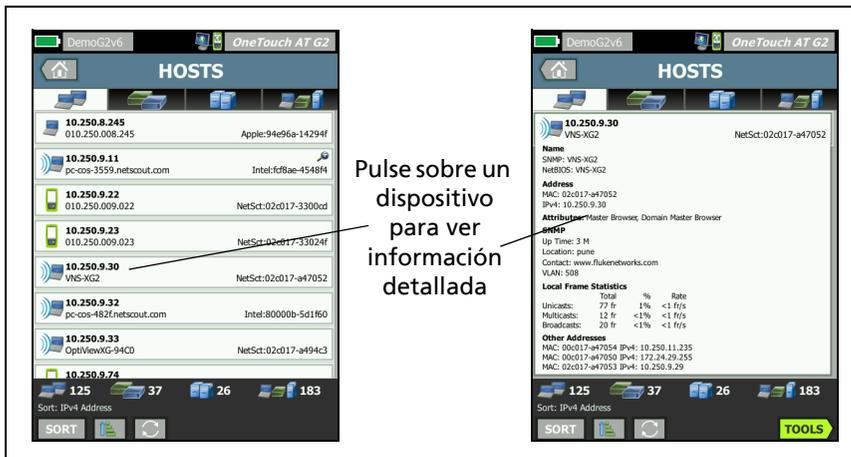
Figura 71. Visualización de los detalles de dispositivos alámbricos
