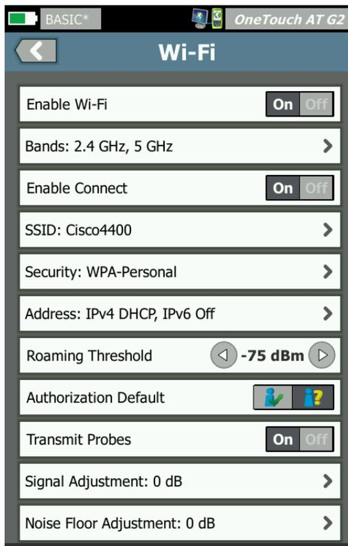
Figura 23. Pantalla Configuración de prueba de Wi-Fi
