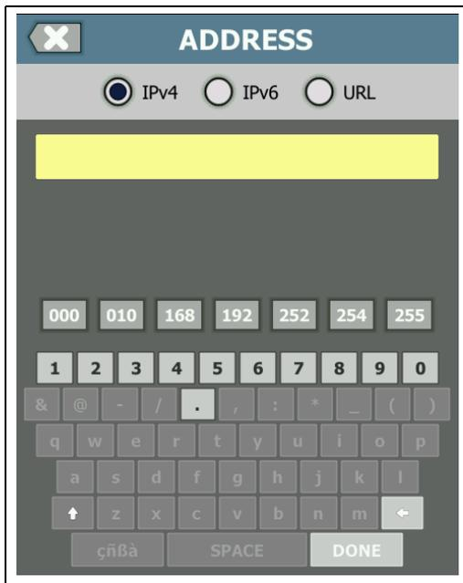
Figura 15. Teclado para ingreso de dirección IPv4
