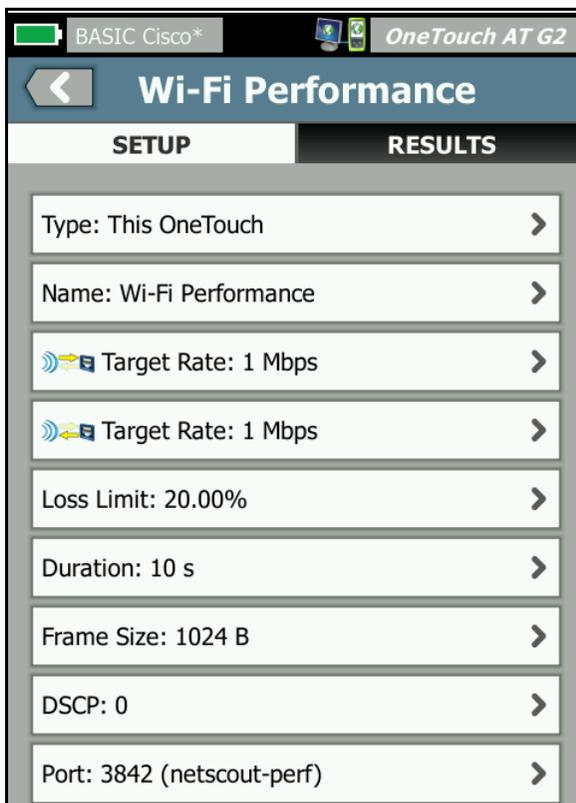
Figura 65. Ficha Configuración de rendimiento de Wi-Fi
