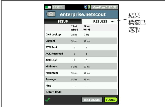
圖 27。連線 (TCP) 測試結果標籤
