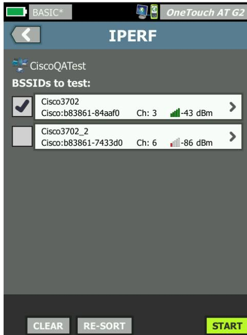
圖 120. 選擇用於 iPerf 測試 BSSID
