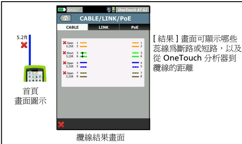
圖 34。發生短路及斷路的無端纜線
