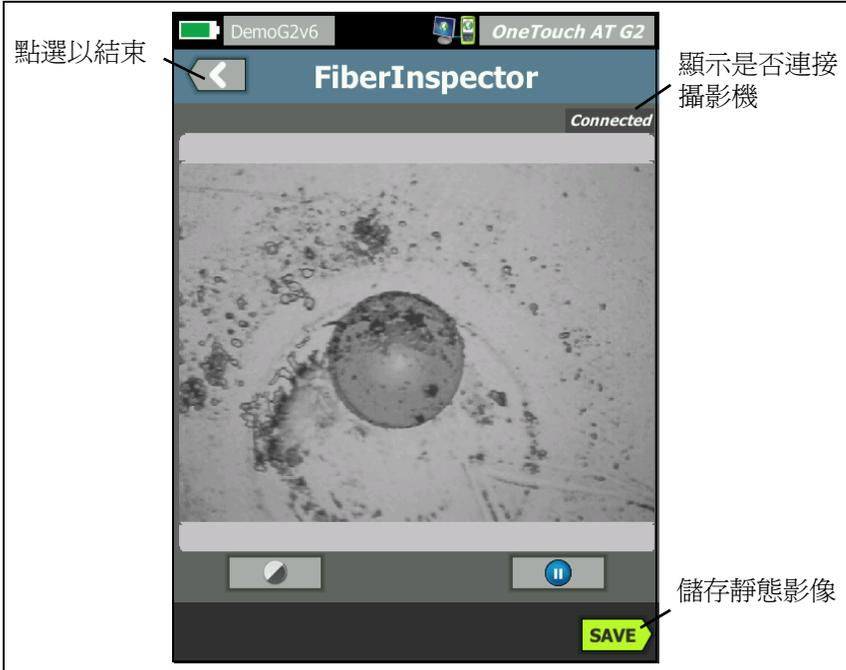
圖 124。端面的 FiberInspector 影像
