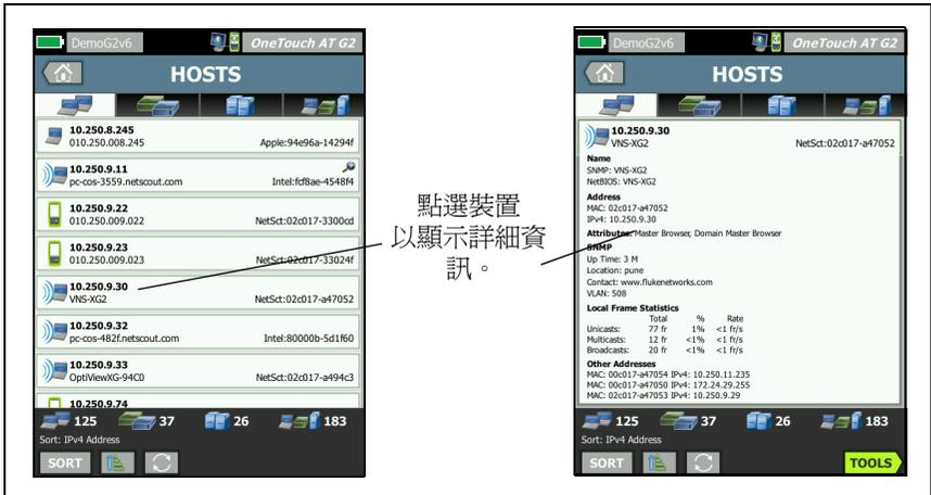
圖 71。顯示有線裝置的詳細資料
