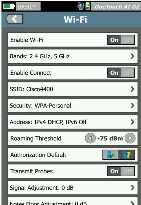
圖 137。Wi-Fi 測試設定值畫面
