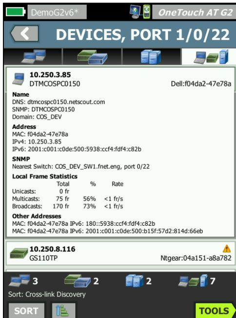
圖 81。MultiPort - 連接埠上的裝置詳細資料畫面
