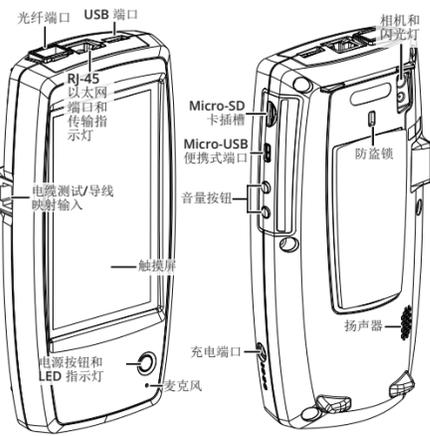
LinkRunner G2 是一款基于 Android 系统的网络测试和故障排查工具。该工具让网络专家能够轻松验证网络的可用性和电缆的连通性，以及轻松识别网络和端口。LinkRunner G2 还可在其他 NetAlly 测试仪执行的性能测试中用作包反射器。
