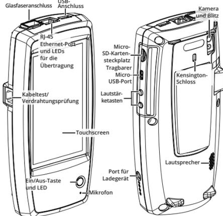
Der LinkRunner G2 ist ein Android-basiertes Tool für Netzwerktests und zur Fehlersuche. Damit können Netzwerkexperten ganz einfach die Netzwerkverfügbarkeit und die Kabelverbindung überprüfen sowie Netzwerke und Ports erkennen. Der LinkRunner G2 kann auch als Packet Reflector für Leistungstest verwendet werden, die von anderen NetAlly Testern durchgeführt werden.
