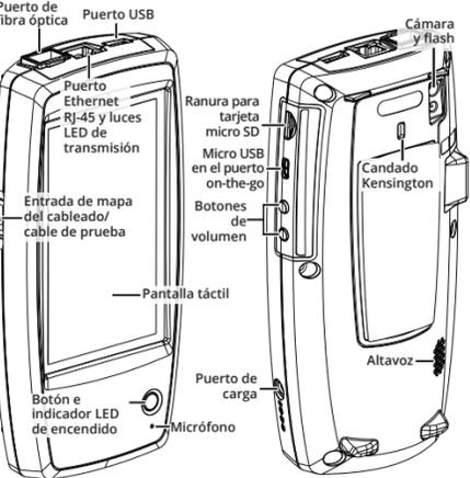
LinkRunner G2 es una herramienta para solucionar problemas y para probar redes con sistema operativo Android. Permite que los profesionales de conexión en redes verifiquen con facilidad la disponibilidad de las redes y la conectividad de los cables, además de identificar redes y puertos. LinkRunner G2 también se puede utilizar como un reflector de paquetes para las comprobaciones de rendimiento que se realizan con otros comprobadores NetAlly.
