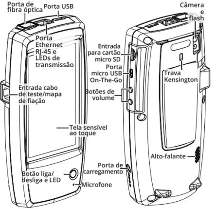
O LinkRunner G2 é uma ferramenta de solução de problemas e testes de rede com base no Android. Ele permite que profissionais de rede verifiquem facilmente a disponibilidade da rede e a conectividade de cabos, além de identificar redes e portas. O LinkRunner G2 também pode funcionar como um refletor de pacotes para executar testes de desempenho por outros testadores NetAlly.
