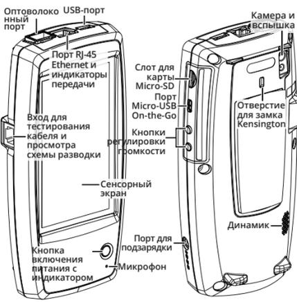
LinkRunner G2 представляет собой прибор на базе Android для тестирования и диагностики сетей. Он позволяет сетевым специалистам с легкостью проверять доступность сетей и кабельные подключения, а также идентифицировать сети и порты. LinkRunner G2 также можно использовать в качестве рефлектора пакетов для тестов производительности, запущенных другими тестерами NetAlly.
