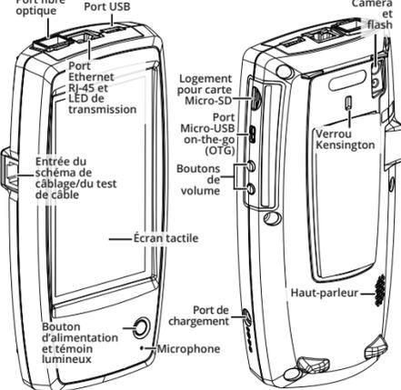
Le LinkRunner G2 est un outil de dépannage et de test de réseau sous Android. Il permet aux professionnels des réseaux de vérifier facilement la disponibilité d'un réseau et le câblage, ainsi que d'identifier les réseaux et les ports. Le testeur LinkRunner G2 peut aussi fonctionner comme un réflecteur de paquets pour des tests de performance réalisés avec d'autres testeurs NetAlly.
