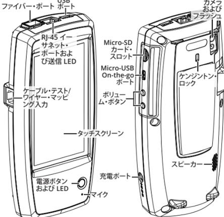
LinkRunner G2は、Android ベースのネットワーク・テストおよびトラブルシューティング・ツールです。ネットワークの可用性とケーブルの接続の検証が簡単で、ネットワークとポートの特定を行えます。また、他の NetAlly テスターから実施する性能テストのパケット・リフレクターとして LinkRunner G2 を使用することもできます。
