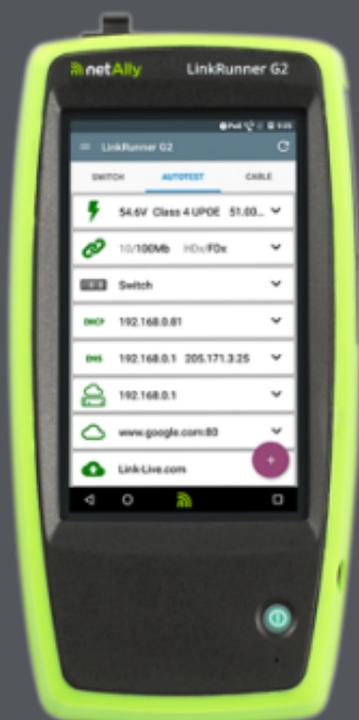
O LinkRunner G2 é uma ferramenta de solução de problemas e testes de rede com base no Android. Ela permite que os profissionais de redes verifiquem a conectividade de rede e a funcionalidade de PoE e validem o cabeamento com facilidade. O LinkRunner G2 também pode funcionar como um refletor de pacotes para executar testes de desempenho por outros testadores NetAlly.
