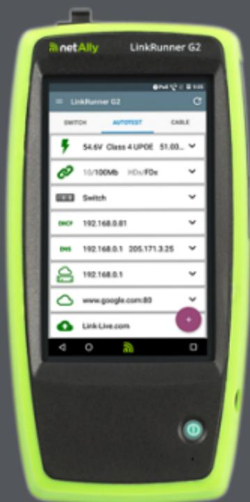
LinkRunner G2 es una herramienta basada en Android para analizar redes y solucionar problemas. Permite a los profesionales de redes verificar fácilmente la conectividad de la red, la funcionalidad PoE y validar el cableado. LinkRunner G2 también puede actuar como un paquete reflector para pruebas de rendimiento ejecutadas por otros probadores de NetAlly.
