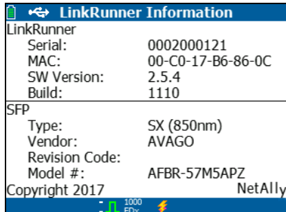
图 13. LinkRunner 信息屏幕 (已连接光纤适配器)
