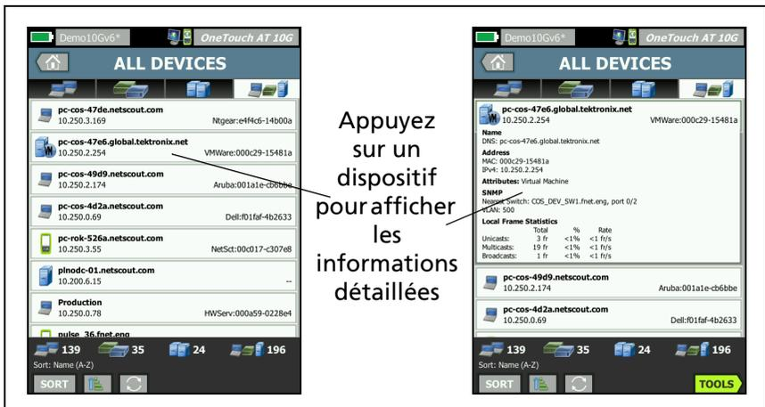
Figure 55. Affichage des détails des dispositifs filaires
