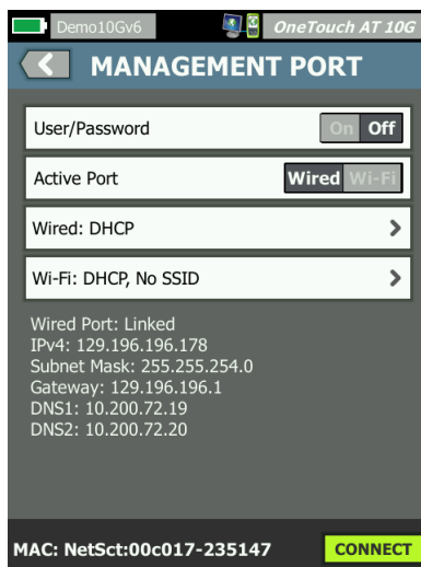
図 79. 有線でリンクされた [Management Port (管理ポート)] 画面
