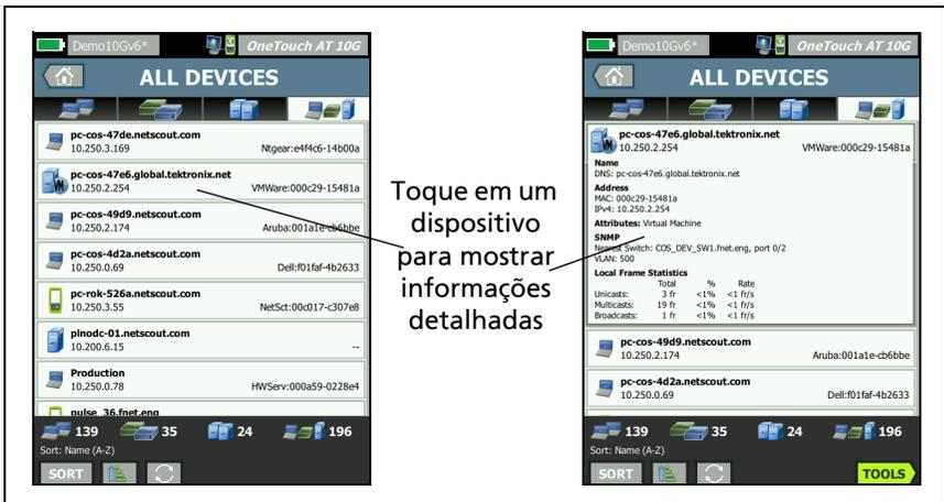
Figura 55. Exibição de detalhes de dispositivo com fio
