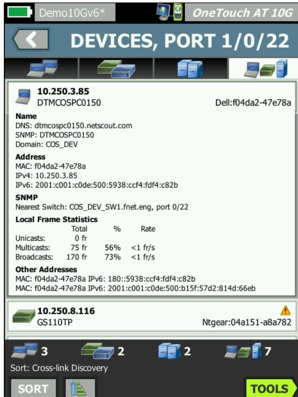
Figura 65. Multiporta - Dispositivo na tela Detalhes da porta
