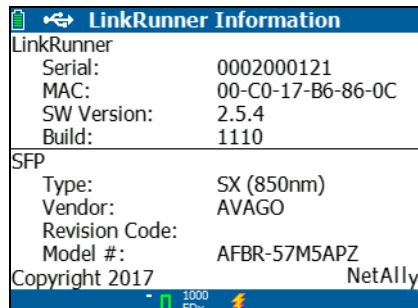
Imagen 13. Pantalla de información sobre LinkRunner con adaptador de fibra conectado
