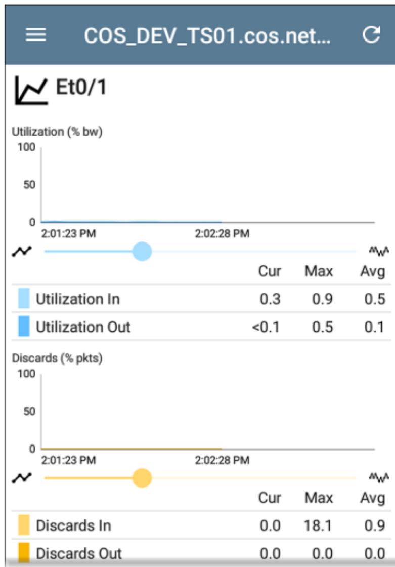
统计屏幕显示利用率、数据包丢弃、数据包错误的实时趋势图。参考[趋势图](#)有关图形平移和缩放控件概述的主题。
