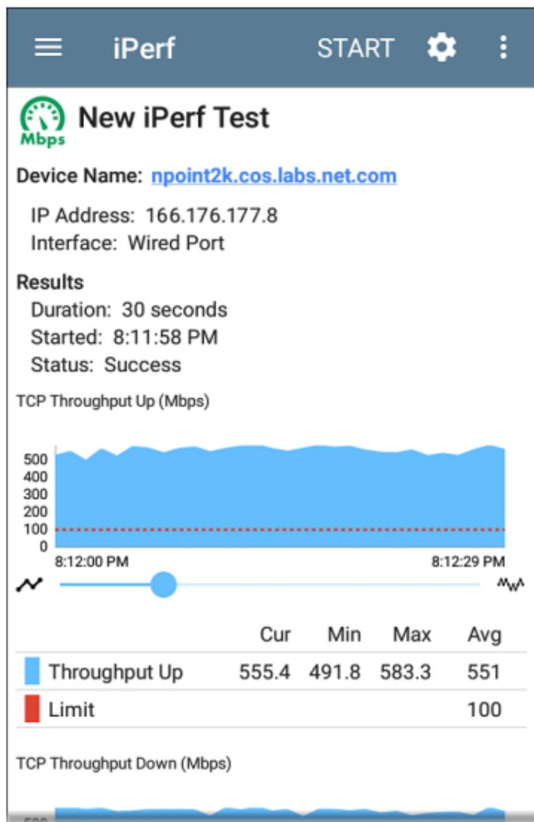
测试特性和状态显示在 iPerf 结果屏幕的顶部，而屏幕的下部显示 TCP 或 UDP 上传和/或下载速度的实时图表。
