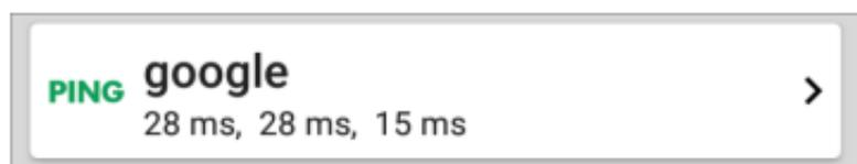
Ping 卡显示在 Ping 测试设置中输入的 Ping 测试名称以及来自目标的三个 Ping 响应时间。
