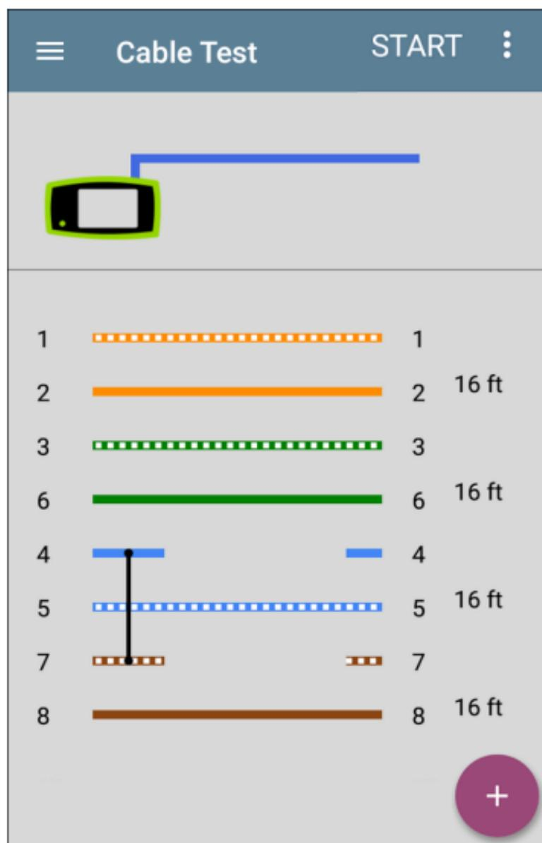
此末端接电缆测试图像显示了针脚 4、5 和 7 之间的短路电缆。
