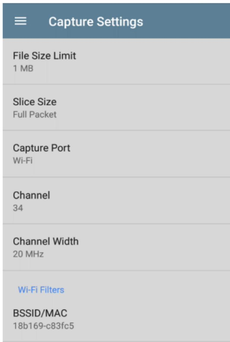
**文件大小限制**: 触摸此字段以指定捕获文件的大小。默认大小为 **1 MB**, 允许的最大大小为 **1000 MB**。当捕获的文件达到此大小时, 捕获停止。当捕获运行时, 捕获屏幕会在捕获数据时显示当前文件大小。
