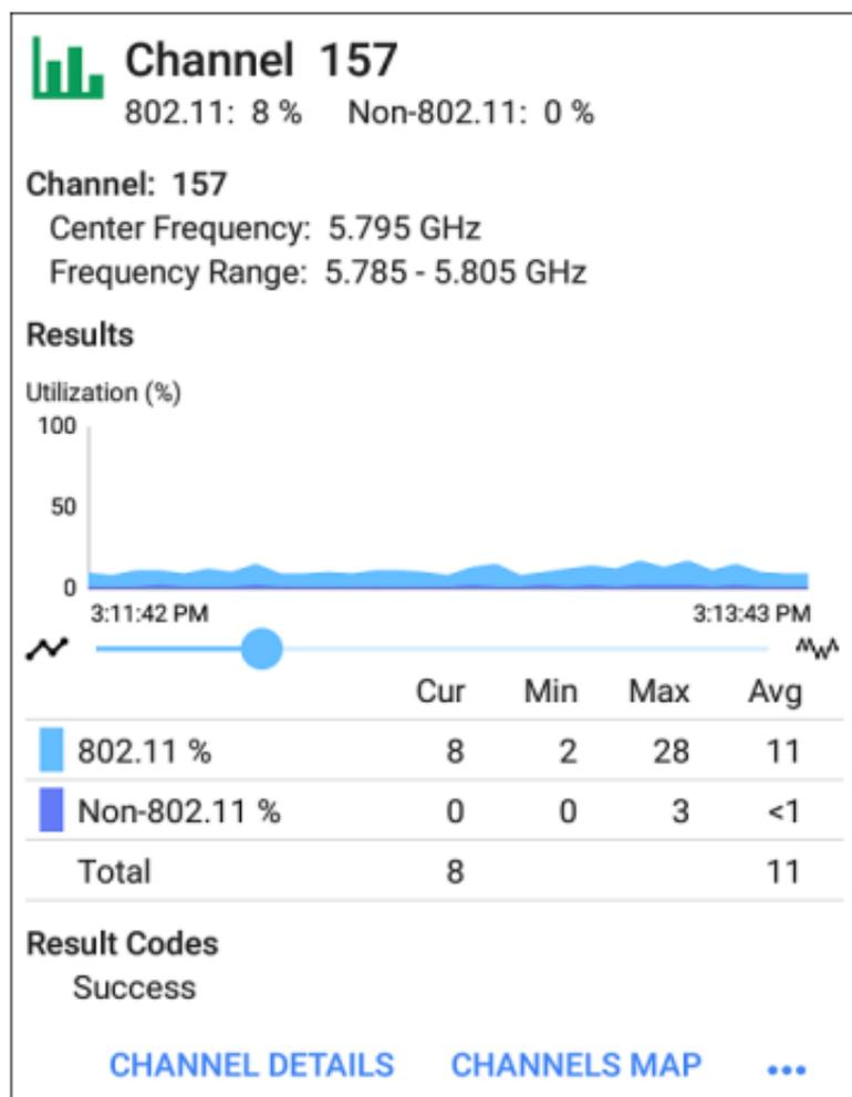
通道测试结果屏幕指示中心频率和频率范围连接通道以及实时利用率图。
