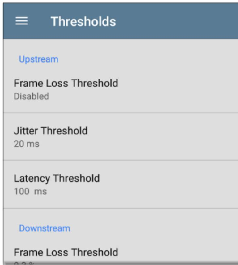
点击每个阈值字段以选择或输入允许的最大值。如果测量值超过阈值，则测试失败。
