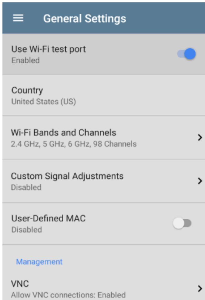
NetAlly 还建议您在设置 Wi-Fi 测试配置文件之前启用所有 Wi-Fi 频段和频道：
