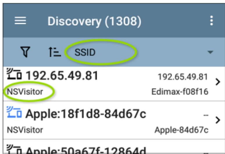
选定的排序选项显示在设备列表上方的排序栏中，每个设备的排序特征显示在设备类型图标下。在上图中，所有与“NSVisitor”SSID 关联的设备都排序在一起。同一 SSID 上的各个设备按数字和字母顺序排列。
