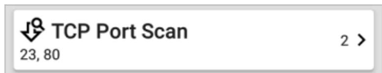
此卡片列出开放端口号并显示开放端口总数。点击卡片打开TCP 端口扫描屏幕。
