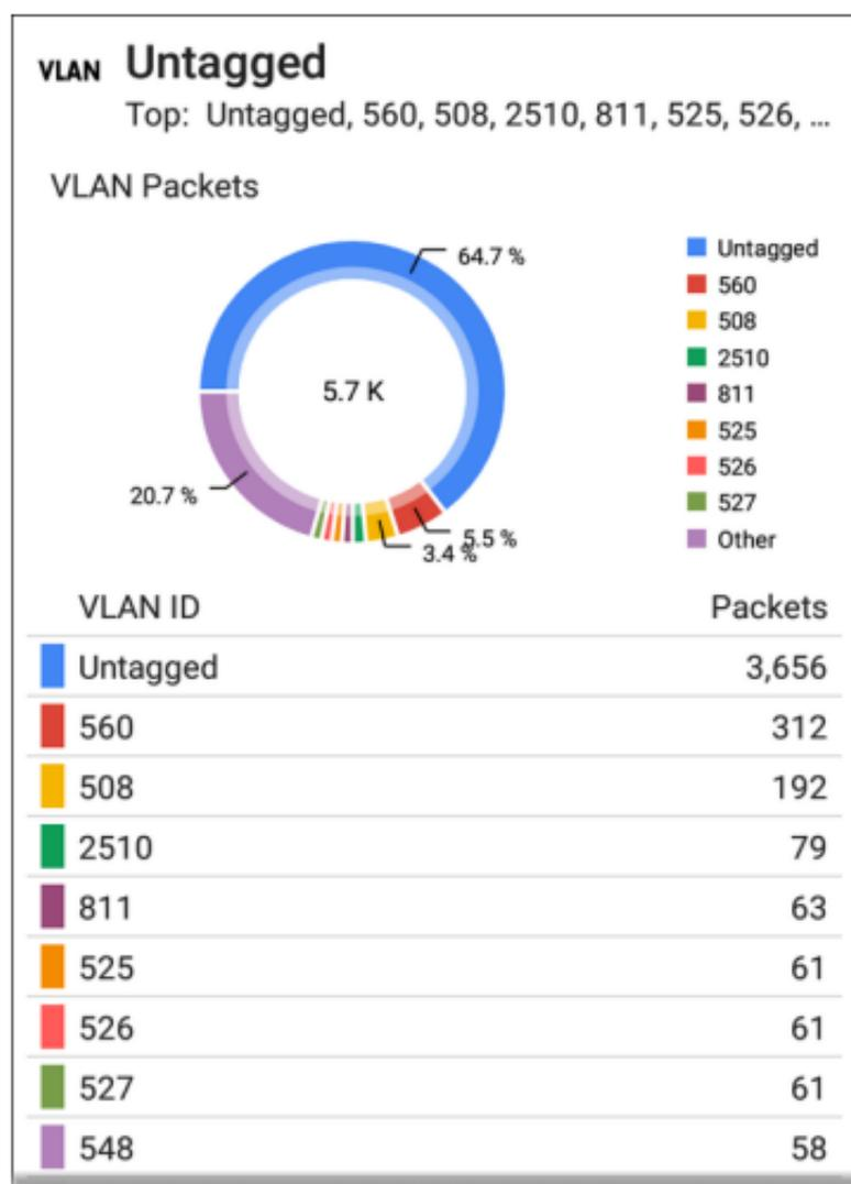
VLAN 测试屏幕显示实时流量ESnXG CE在顶级 VLAN 上检测。最多 9 个流量最高的 VLAN 显示为饼图的彩色部分。VLAN 屏幕下方的表格列出了所有可见的 VLAN。
