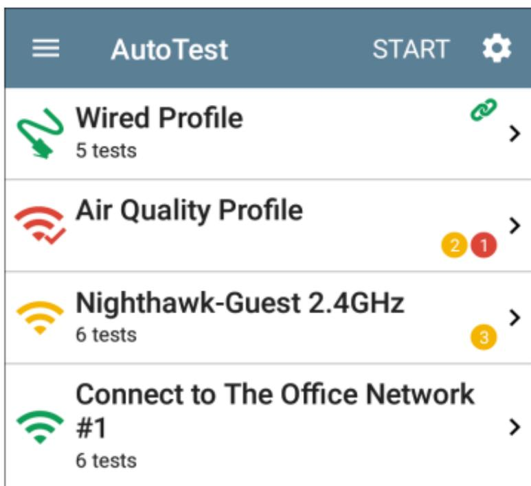
AutoTest 屏幕显示与配置文件、测试或测量类型相对应的图标。运行后，这些图标会改变颜色以指示测试状态：
