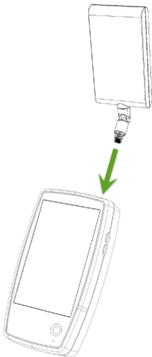
2. 在射频和流量统计界面，点击外接天线切换以启用外部天线。
