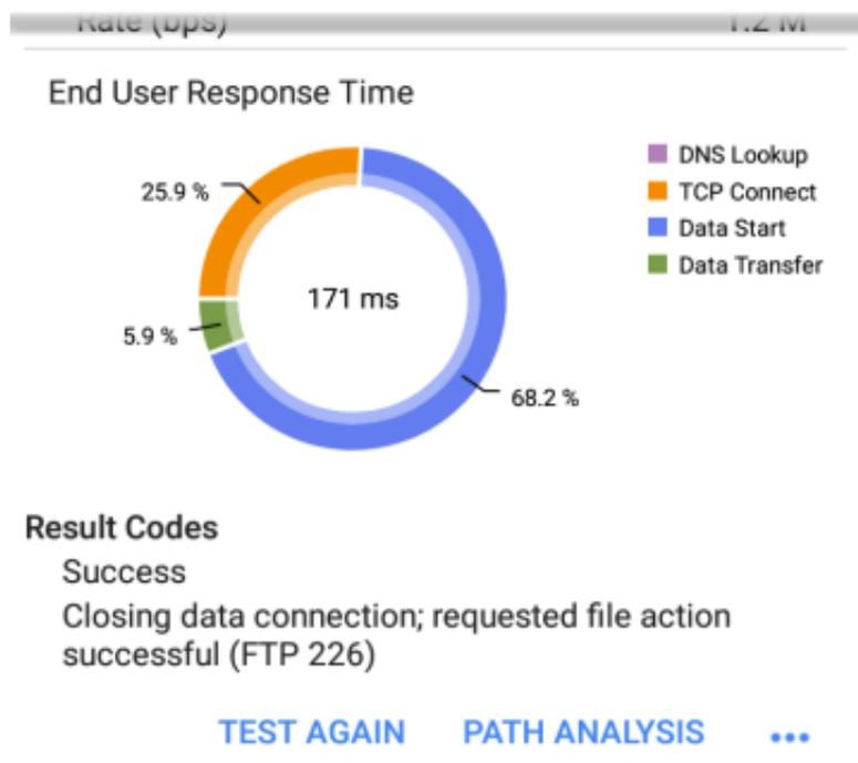
**最终用户响应时间:**测试每个阶段的时间饼图(DNS、查找、TCP 连接、数据启动和数据传输)
