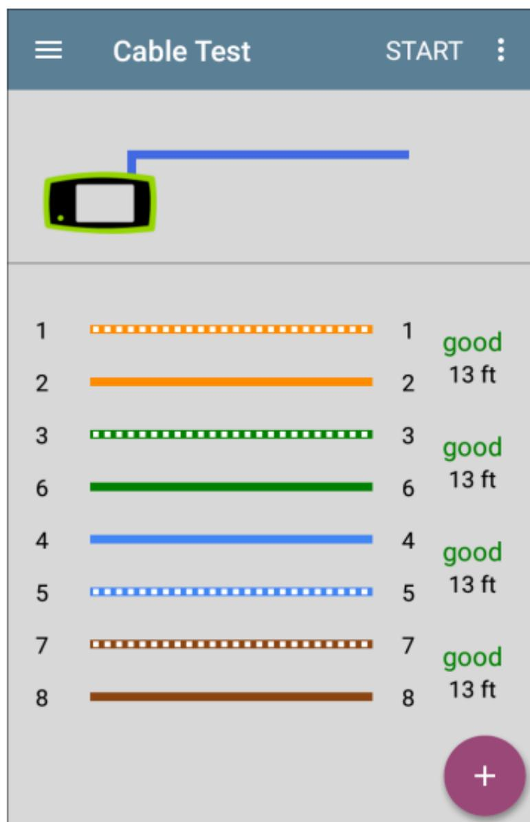
当电缆未检测到故障时，长度测量值上方的每对电缆旁边会显示“良好”。检测电缆中“分裂”或“开路”的电缆测试也会显示相应的词。
