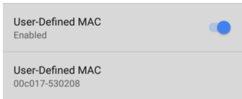
此设置仅影响[有线测试端口](#)。点击切换开关可为该配置文件启用用户定义的 MAC 地址。启用后, 切换设置下方会出现一个额外的用户定义 **MAC** 字段。(如果此配置文件当前没有值, 则该字段显示在常规设置的[有线](#)部分中定义的用户定义的 MAC 地址(如果有。)) 点击下方字段为 ESnXG CE 输入所需的 MAC 地址。启用此用户定义的 MAC 后, XXX [关于 XXX](#) 屏幕和相关测试结果屏幕上的 MAC 地址旁边会出现(用户定义)。
