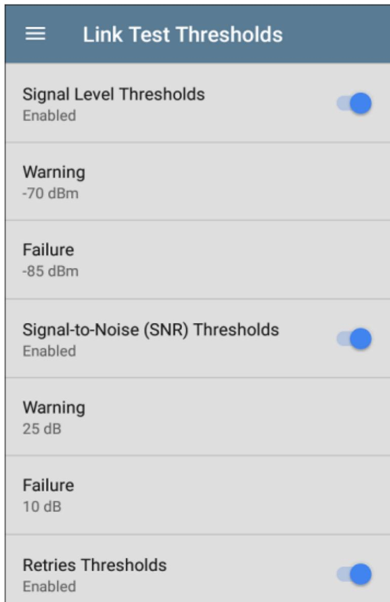
触摸每个字段以选择新值或输入自定义值。每个阈值还有一个切换按钮，允许您完全禁用基于该测量的评分。
