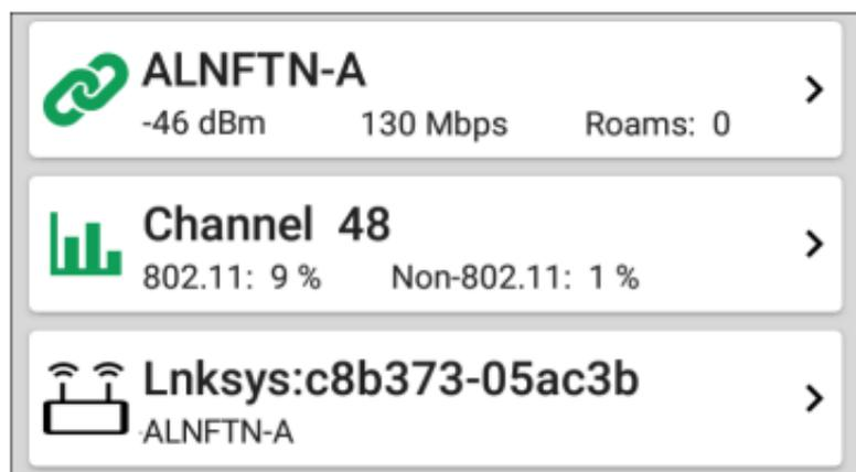
链接和通道卡实时更新以显示连接测量值 ESnXG CE保持连接到无线网络。
