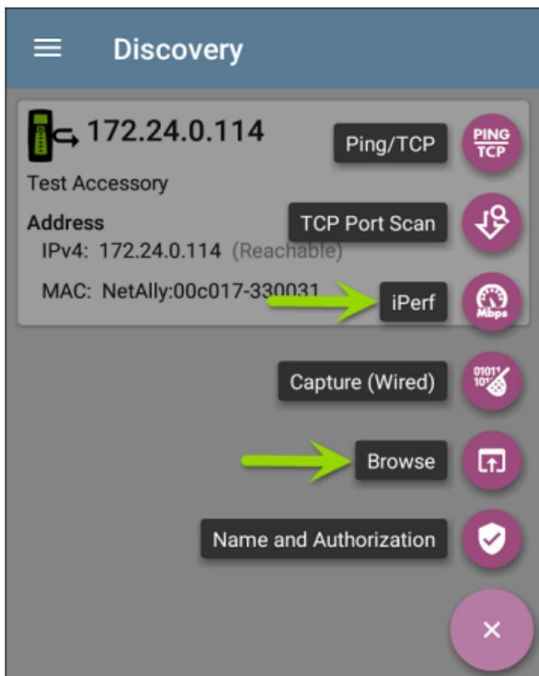
3. 然后，选择 **iPerf** 应用按钮。iPerf 应用程序打开时使用从 **Discovery** 中的测试附件填充的 IP 地址。
