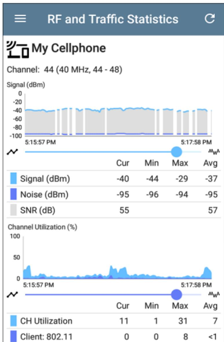
信号图以浅蓝色显示信号，以深蓝色显示噪声，以及计算的 SNR。
