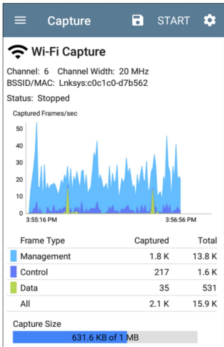
在上面显示的测试中，该应用已捕获信道 6 上显示的所有三种 Wi-Fi 帧类型，并显示 BSSID。图表下方表格中的总测量值代表所有看到的帧，而捕获的帧则是符合过滤参数的帧。
