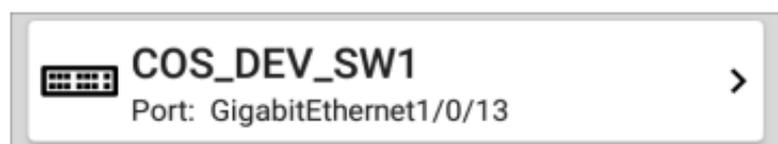
交换机测试卡显示最近的交换机和端口名称。如果测试成功，开关图标将保持黑色。
