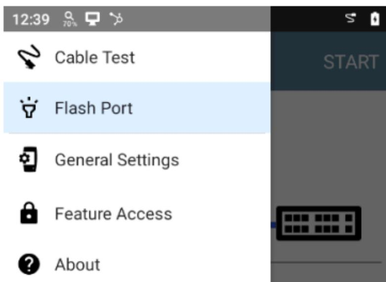
3. 点击 **Flash Port** 打开 Flash Port 屏幕。如果与交换机的连接良好，则会出现一条蓝线将测试单元图标连接到交换机图标。
