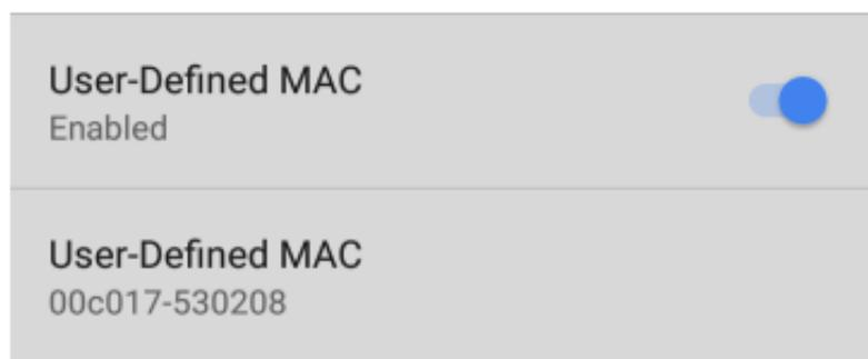
此设置会影响 [只有有线测试端口](#) 点击切换开关以启用专门为此配置文件的用户定义的 MAC 地址。启用后，一个额外的用户定义的 MAC 字段出现在切换设置下。(如果此配置文件当前没有值，则该字段显示用户定义的 MAC 地址(如有) 定义在 ["有线常规设置" on page 88](#) 常规设置部分。) 点击下方的字段以输入所需的 MAC 地址。ESnXG CE 当启用此用户定义的 MAC 时，(用户定义) 出现在 MAC 地址旁边 [关于](#) 屏幕和相关测试结果屏幕。
