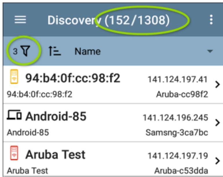
返回主发现屏幕，屏幕标题显示已发现设备总数中已过滤设备的数量(在上图中，总共1308台设备中有152台已过滤设备)。
