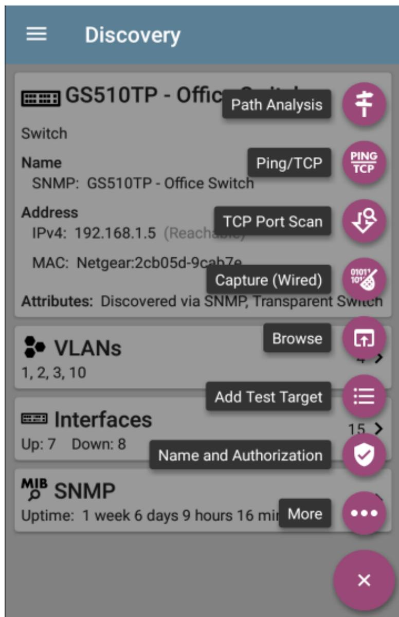
出现在测试应用程序中的浮动操作菜单在相关章节中有更具体的描述。例如，[Discovery App 浮动操作菜单](#) 有关更详细的说明，请参阅 [Discovery 应用程序](#) 章节。
