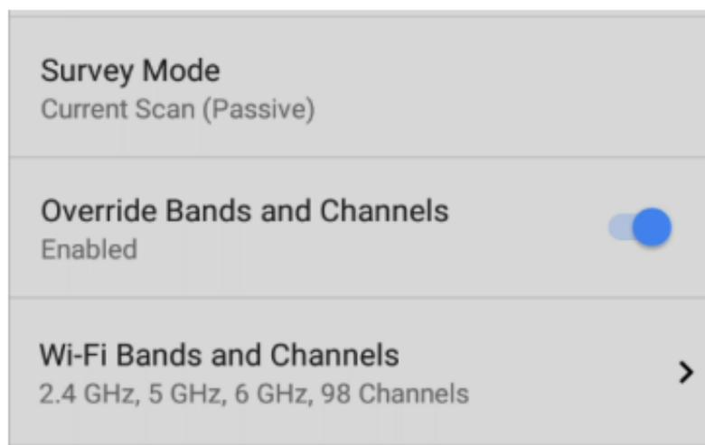
(仅为被动测量模式启用。) 点击 **覆盖频段和频道** 启用与中定义的值不同的频段和通道的选择 [常规设置](#)。(这些覆盖设置仅用于 AirMapper 勘测。) 启用此设置会显示 Wi-Fi 频段和频道设置。
