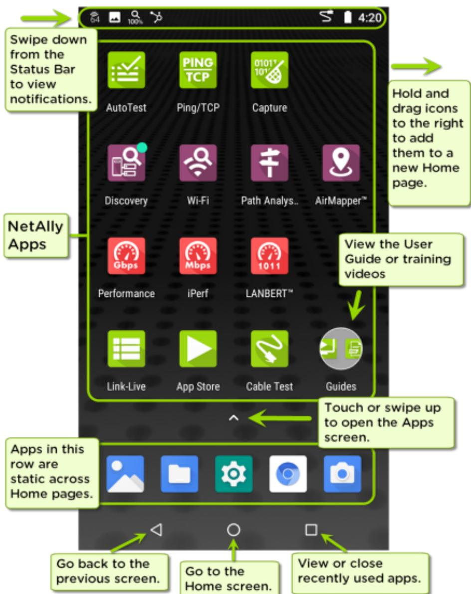
与其他手持式设备一样，您的 EtherScope nXG Controlled Edition 主屏幕是可定制的。上图显示了默认配置，但您可以添加、删除和重新组织应用程序图标和小部件以满足您的目的。
