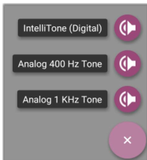
3. 为您的探头选择合适的音调选项。这通过电缆发出音调，探头检测到它，让您可以追踪电线或在开关柜中找到它。
