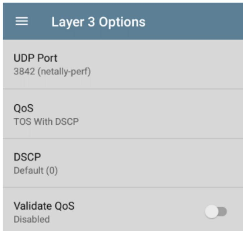
**UDP 端口:** 点击以输入特定的 UDP 端口号。这可以帮助您模拟为特定用途(例如视频、语音或备份数据)保留的端口上的优先流量,或匹配防火墙允许的端口。
