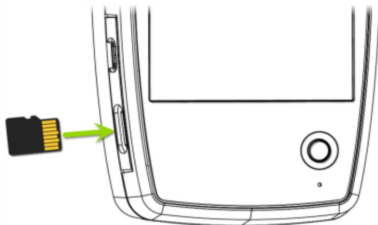
当正确定位时，卡片应该能够轻松地滑入。您可能需要使用一个纸夹或指甲来小心地推动SD卡，使其插入足够深从而触发弹簧机制，以便插入和拔出。
