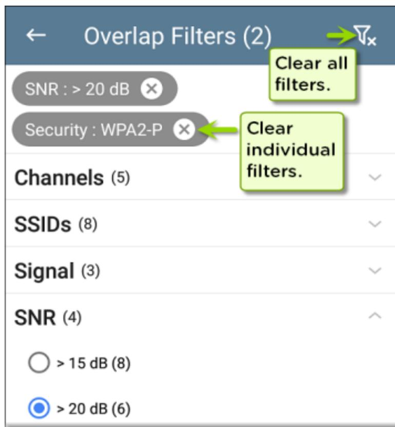
选择过滤器后，这些活动过滤器将显示在“过滤器”屏幕的顶部。
