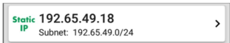
静态 IP 卡显示配置的 IP 和子网地址。触摸卡片以打开测试结果屏幕。
