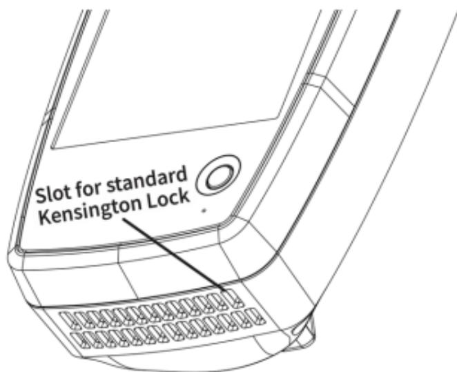
标准Kensington锁插槽位于设备底部右侧前方的通风孔上, 如下所示。
