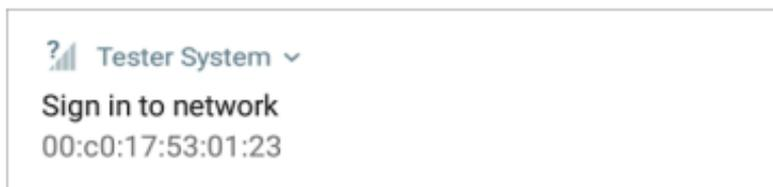
要通过 HTTP 测试，您必须选择通知并在门户网站上输入所需的凭据。否则，HTTP 测试将失败，结果代码为“检测到网页认证 (25)”。
