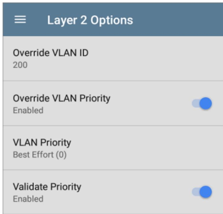
**覆盖 VLAN ID:**轻触以选择或输入 VLAN ID 编号。覆盖 VLAN ID 功能使用特定 VLAN(例如,用于语音、视频或数据的 VLAN) 标记帧。如果未启用覆盖 VLAN ID, 则 VLAN 将设置为用于有线测试端口的值。
