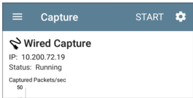
捕获的当前状态和任何应用的过滤器显示在捕获类型下（有线或 Wi-Fi）。上图表明该应用程序仅捕获 IP 10.200.72.19 的流量。
