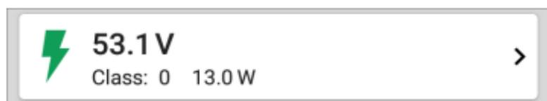
以太网供电 (PoE) 测试卡显示测得的电压、等级和功率。
