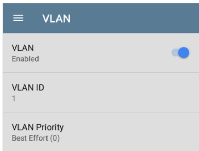
轻触打开 VLAN 设置屏幕。向右滑动开关以启用 VLAN 测试。启用此设置还可以启用 [VLAN测试卡](#) 在有线自动测试结果屏幕上。启用后，会出现，**VLAN ID**和**VLAN**优先级的字段出现。轻触这些字段以打开弹出式数字键盘并输入正确的 ID 和优先级。轻触确定保存。
