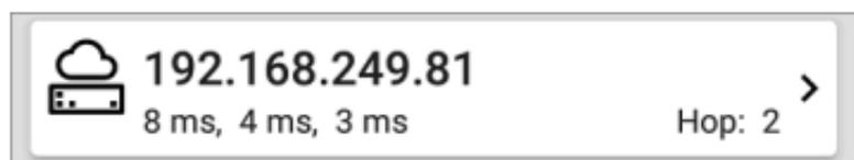
在名称(或 IP)下方，每个 Connect (TCP)、Ping (ICMP) 或 Echo (UDP/7) 的响应时间以毫秒为单位显示。右侧是该设备在路径中的路由器跳数。
