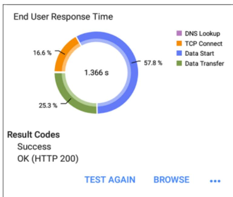
**最终用户响应时间:**测试每个阶段的时间饼图(DNS、查找、TCP 连接、数据启动和数据传输)
