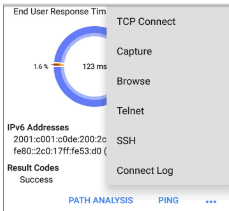
DHCP 测试页上可用的其他操作包括打开[路径分析](#), [Ping/TCP](#), or [抓包](#)填充了 DHCP 服务器地址的应用程序, 在 Web 浏览器中浏览到 IPv4 地址, 启动[Telnet](#) 或者 [SSH](#) 连接, 或者查看[连接日志](#).
