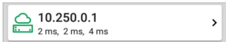
网关测试卡显示网关的IP地址和三个Ping响应时间。
