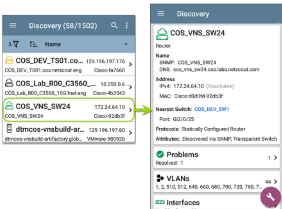
详细信息屏幕上可用的数据和操作因设备类型，连接方式和 ESnXG CE 可以发现的数据而异。换句话说，只有每个设备的可发现信息才会显示在“详细信息”屏幕上。
