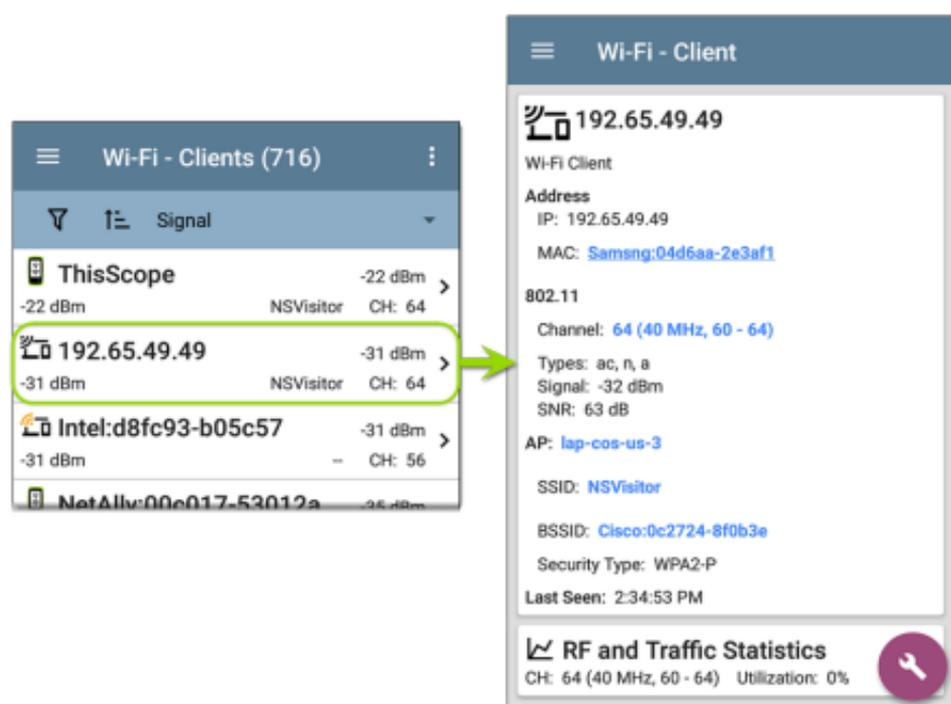
在 Wi-Fi 详细信息屏幕上, 您可以触摸任何蓝色链接的姓名或地址打开链接设备的 Discovery 或 Wi-Fi 应用程序屏幕。
