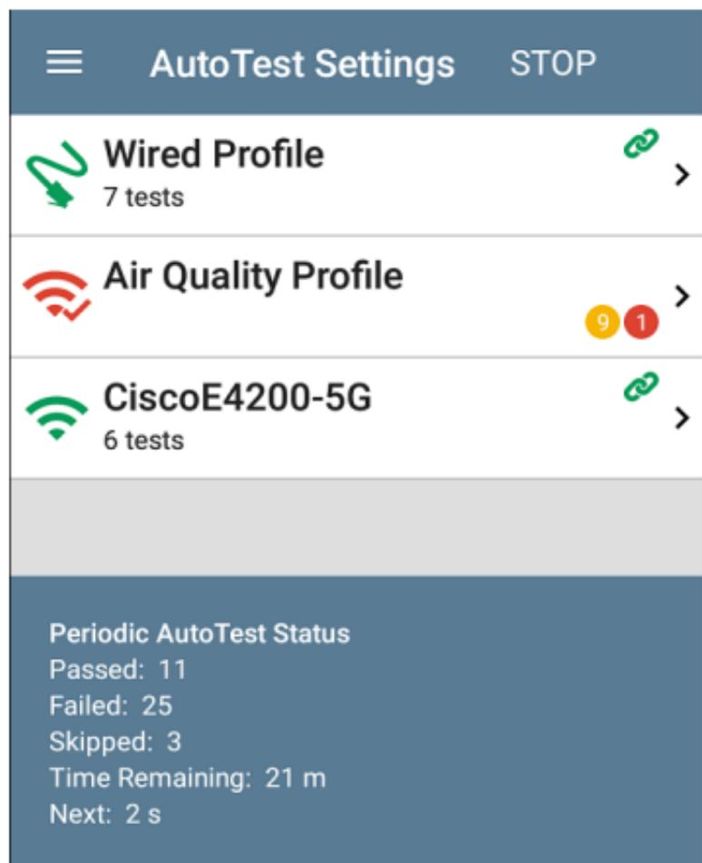
定期自动测试状态汇总在自动测试屏幕的底部。为整个配置文件组的每次运行报告通过和失败，而不是单个配置文件。如果在下一个时间间隔发生时前一个间隔的测试仍在运行，则将跳过定期自动测试，从而无法开始下一次运行。
