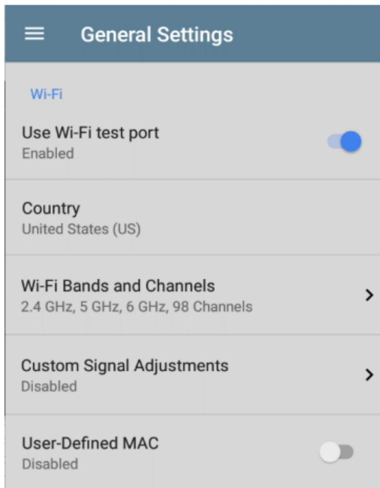
使用 **Wi-Fi 测试端口**: 在测试应用程序中启用或禁用 Wi-Fi 测试、连接和测量, 包括 [自动](#)
