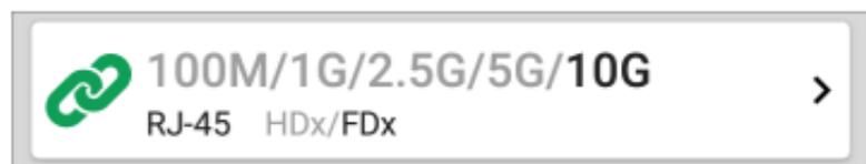
用于铜质以太网连接的链路测试卡显示广告速度和双工能力灰色文本以及检测到的速度和双工黑色文字。
