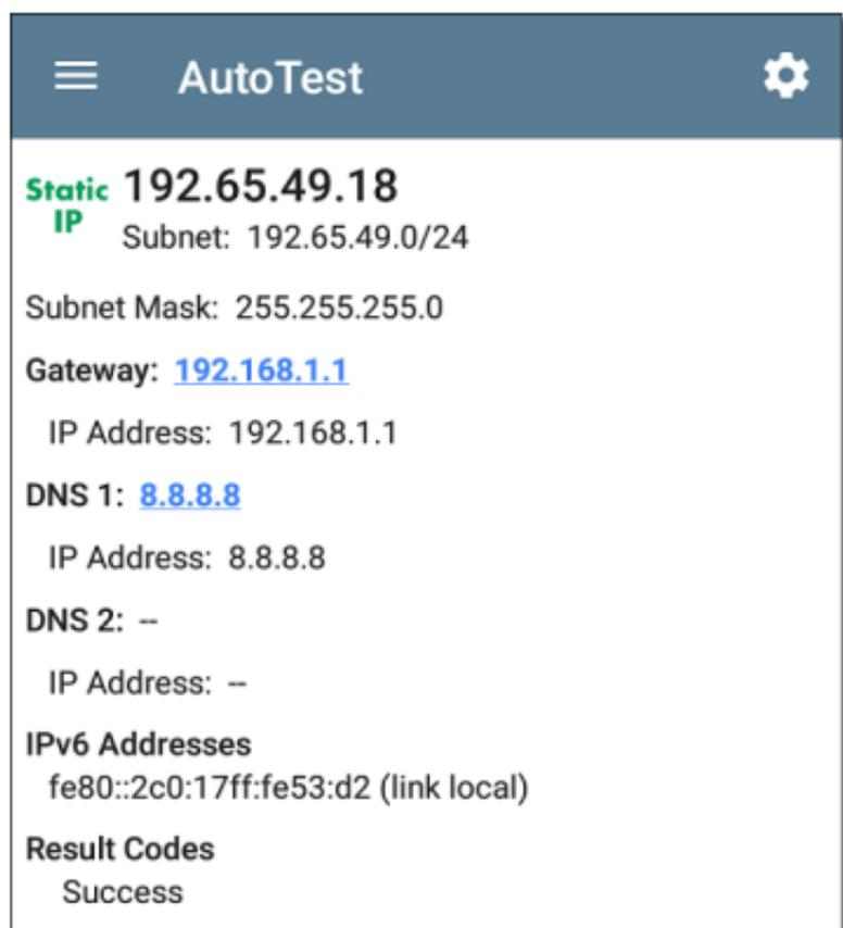
静态 IP 测试屏幕显示配置的地址。
