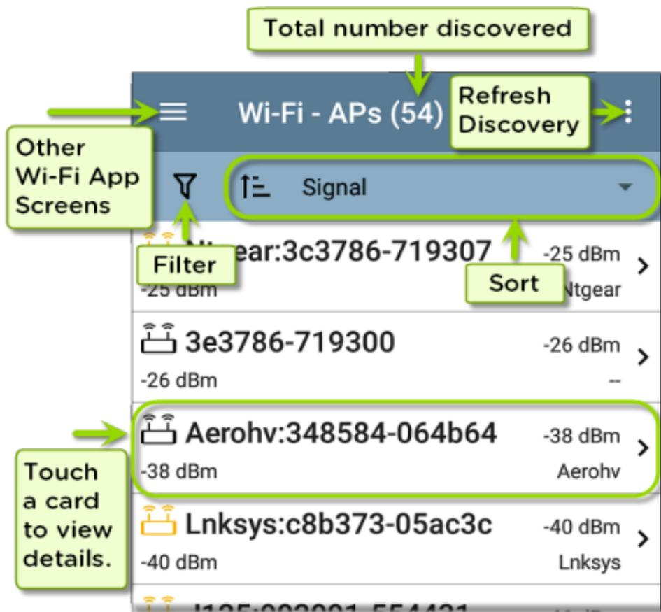
就像在 AutoTest 和其他 ESnXG CE 屏幕上，Wi-Fi 分析中的图标会改变颜色以指示警告 or 失败状况。该应用程序还显示图标蓝色指示不构成警告或故障的问题相关信息，以及绿色表示先前的问题已解决。
