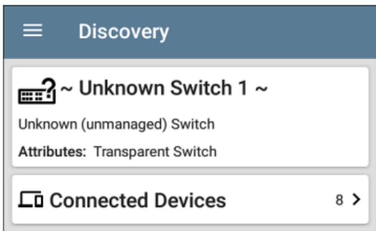
Unknown Switches Details 屏幕显示连接到交换机的设备数量，并允许您通过点击[连接的设备](#)卡片。连接的设备提供有关未知开关可能位于何处的线索。
