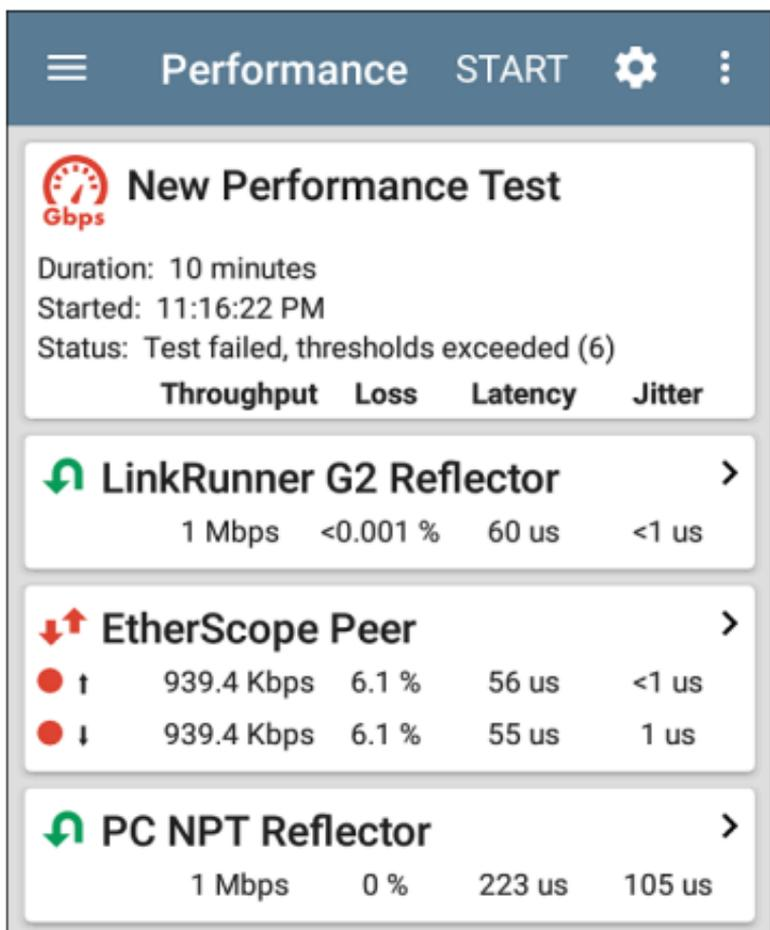
如果您仅使用 Reflector 端点和/或EtherScope nXG Controlled EditionPeer 运行 v1.2 或更新的软件,测试时长不超过 4 小时。如果您正在运行 10 秒的测试,所有结果将在 10 秒后显示。否则,结果每 30 秒更新一次。
