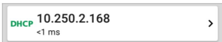
DHCP 测试卡显示 DHCP 服务器的 IP 地址以及完成发现、提供、请求和确认的总时间。
