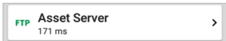
FTP 卡显示在测试设置中输入的测试名称和目标的响应时间。
