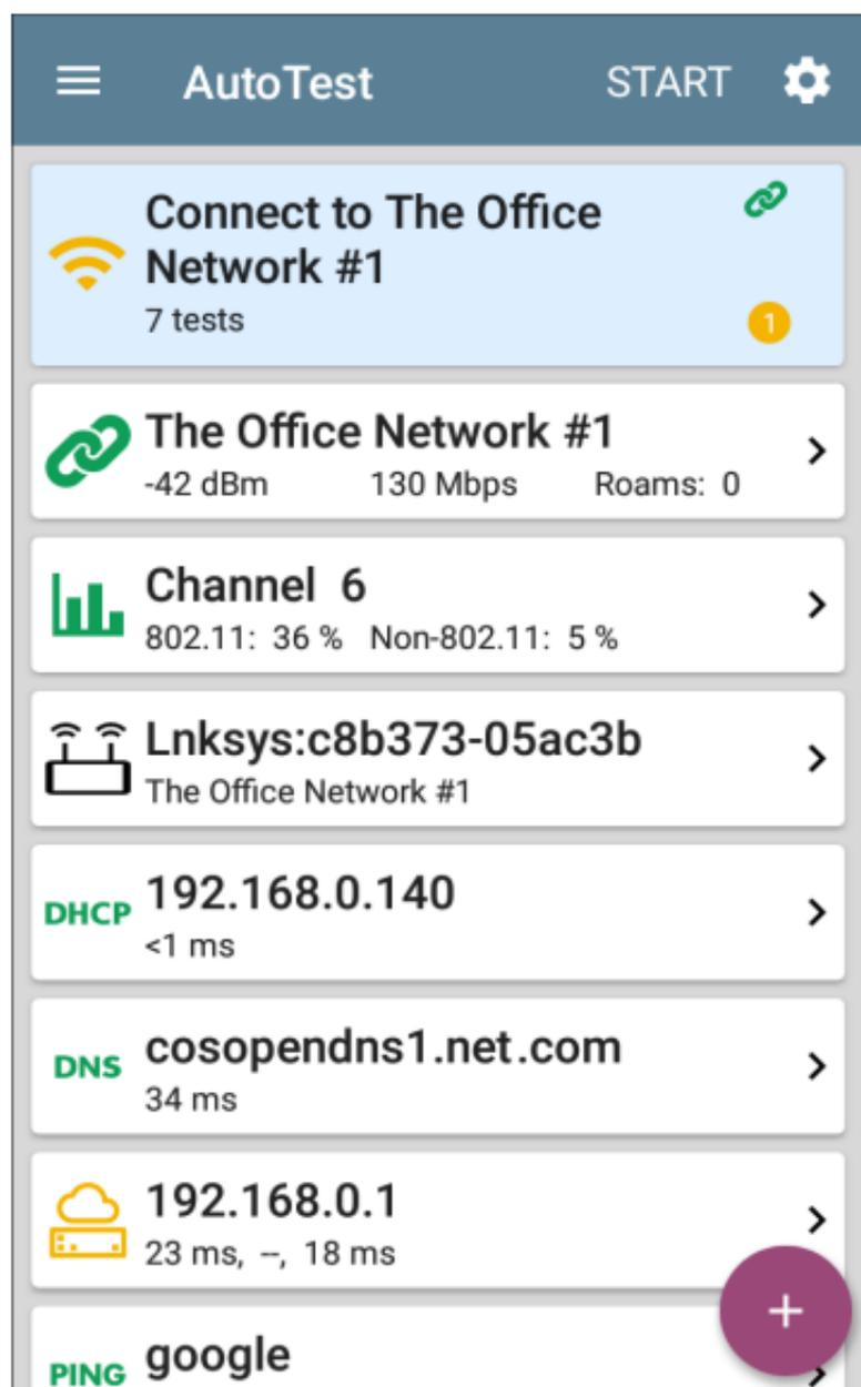
此配置文件连接到 SSID“办公网络 #1”。个人资料正在显示一个警告第二个网关 ping 超时的条件。
