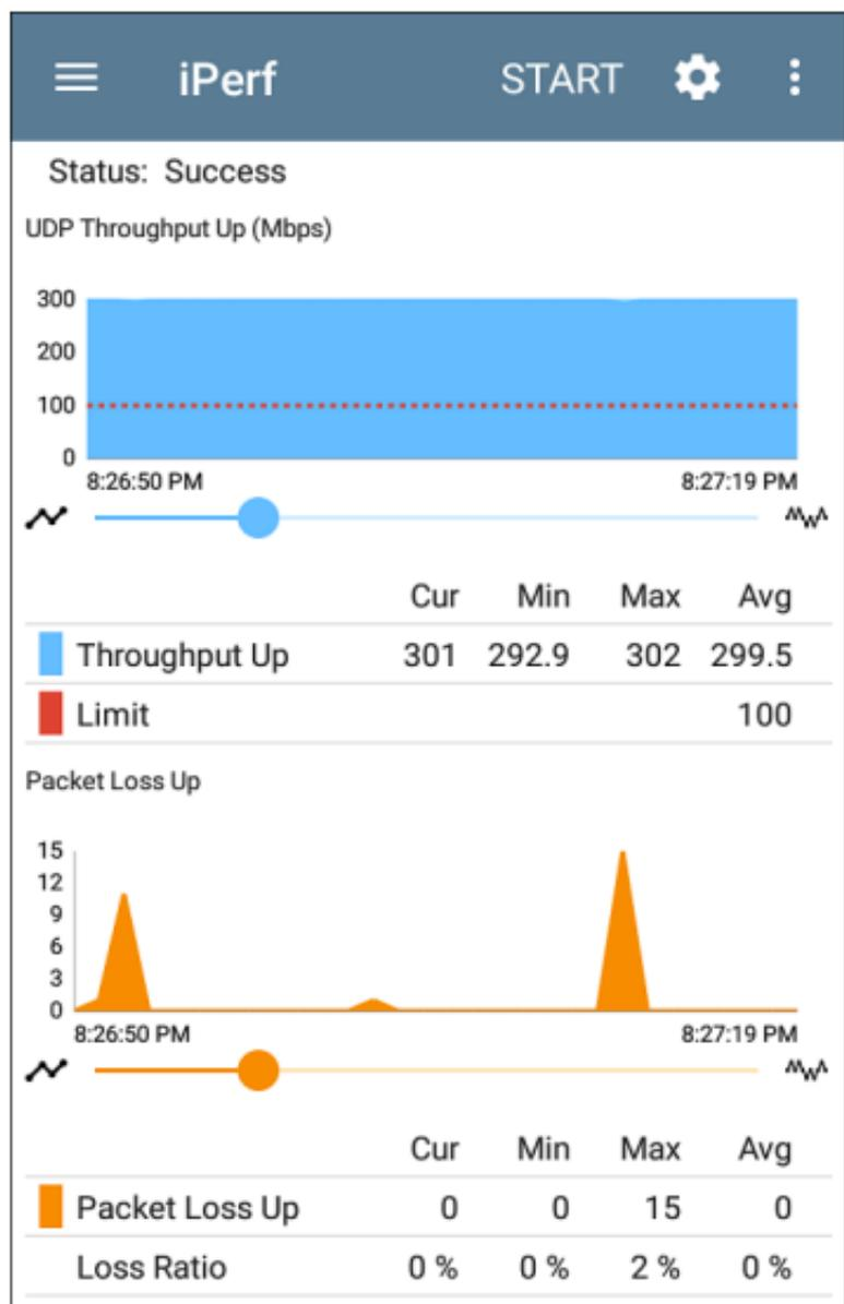
**UDP 数据包丢失向上和向下图:**运行UDP协议测试时, iPerf结果还会显示数据包丢失的图形和表格。丢失数据包的数量和百分比值显示在图表下方的表格中。在上游测试
