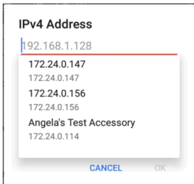
IPv4 地址对话框中的下拉列表显示所有测试附件 LRAT 通过发现 [发现过程](#)，以及声称具有相同功能的任何测试附件 [Link-Live](#) 组织作为您的 LRAT。
